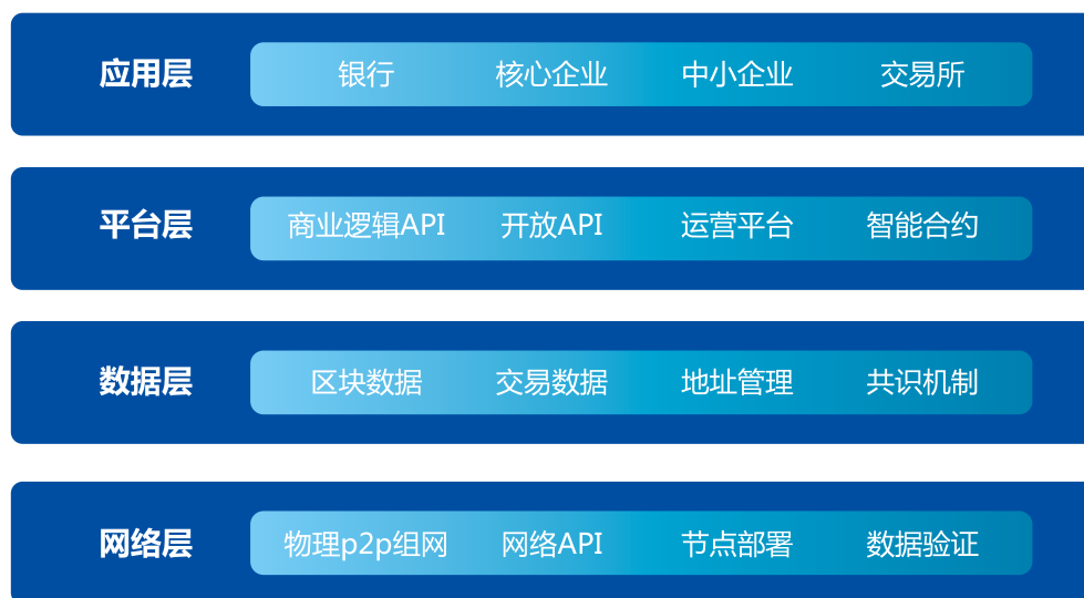
图 23 票据贴现区块链架构
